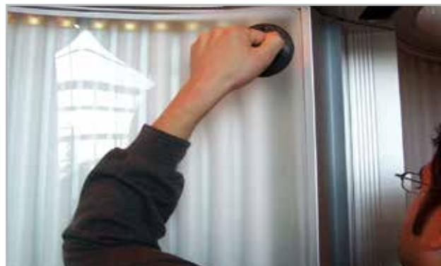
Hinter die Scheibe greifen und die rechte Seite in einer Abwärtsbewegung lösen. Die Scheibe kann entfernt werden.
