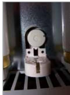
Röhren einbauen: Achten Sie darauf, dass der Röhrenstempel sichtbar ist, da sonst keine Bräunungswirkung erzielt wird.
