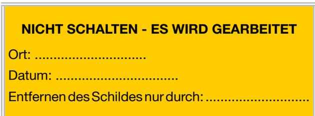
muss immer, sofort, in der Nähe der Sicherungsvorrichtung montiert werden.
